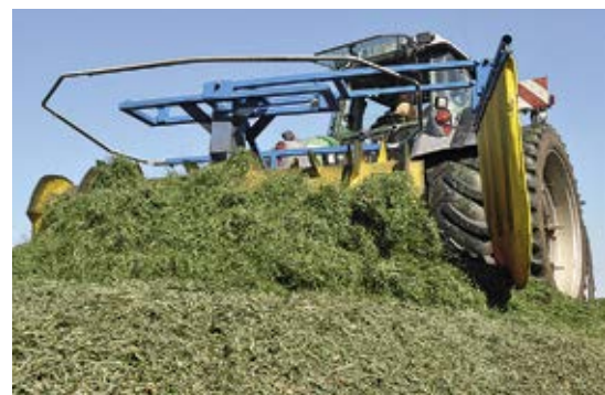
Le Jumbo II est le plus performant (en haut). Attelé à l'arrière, le Magna offre plus de visibilité (en bas). Le déflecteur latéral est bien utile pour éviter les pertes si le vent souffle fort et que le fourrage est sec.
