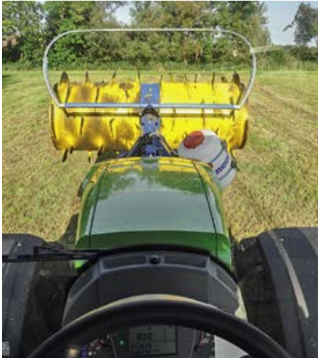
Aufgrund der unterschiedlichen Anbaugeometrien ergeben sich Unterschiede bei der Aushubhöhe, was bei steilen Silagemieten wichtig sein kann (Jumbo II links, Magna rechts). Fotos: Küper, Knötig
