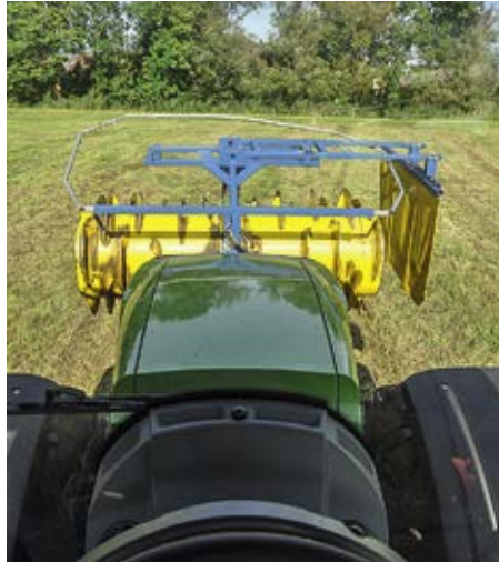
Aufgrund der unterschiedlichen Anbaugeometrien ergeben sich Unterschiede bei der Aushubhöhe, was bei steilen Silagemieten wichtig sein kann (Jumbo II links, Magna rechts). Fotos: Küper, Knötig
