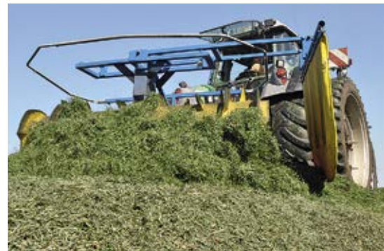
Mehr Leistung hat der Jumbo II (oben). Übersichtlicher im Heck ist der Magna (unten). Bei trockener Silage und viel Wind hilft die seitliche Begrenzung, Verluste zu vermeiden.
