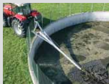
Гомогенизатор жидкого навоза для открытых резервуаров и лагун
