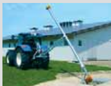
Гомогенизатор жидкого навоза для закрытых резервуаров
